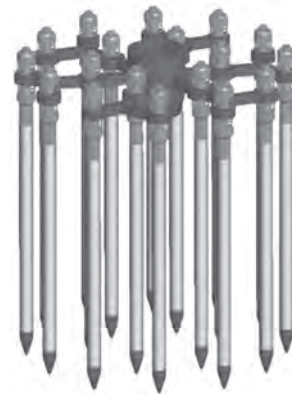
Рис. 3. Поглинаючі стрижні системи управління і захисту (ПС СУЗ) для реакторів ВВЕР-1000
