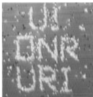
Рис. 2. Аббревиатура названия фирмы на поверхности кремниевой пластины (димеры атомов расположены с промежутками 7,7 Å)
