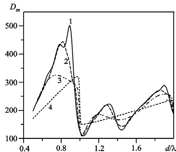
**Рис. 2.** Зависимости КНД от расстояния между элементами – излучателями Гюйгенса антенной решетки, образованной 64 излучателями, с разной формой апертуры: квадратной (кривая 1), прямоугольной (кривая 2), квазилинейной (кривая 3) и линейной (кривая 4)
