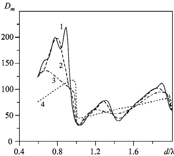
**Рис. 1.** Зависимости КНД от расстояния между элементами антенной решетки, образованной 64 изотропными излучателями, с разной формой апертуры: квадратной (кривая 1 – 8×8 элементов), прямоугольной (кривая 2 – 4×16 элементов), квазилинейной (кривая 3 – 2×32 элементов) и линейной (кривая 4 – 1×64 элементов)
