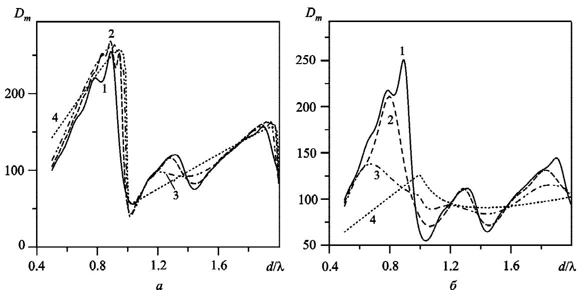
**Рис. 4.** Зависимости КНД от расстояния между элементами – полуволновыми вибраторами антенной решетки из 64 излучателей с квадратной формой апертуры (кривые 1), прямоугольной (кривые 2), квазилинейной (кривые 3) и линейной (кривые 4): *a* – вибраторы параллельны оси *OX*; *б* – вибраторы параллельны оси *OY*
