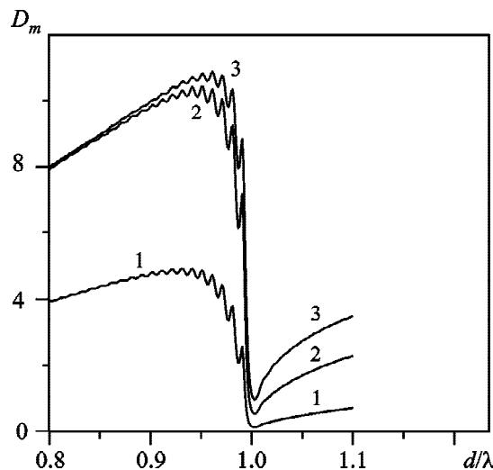
**Рис. 6.** Зависимость КНД квадратной решетки из  $100 \times 100$  излучателей от расстояния между ними: кривая 1 – изотропные излучатели; кривая 2 – излучатели Гюйгенса; кривая 3 – открытые концы прямоугольных волноводов
