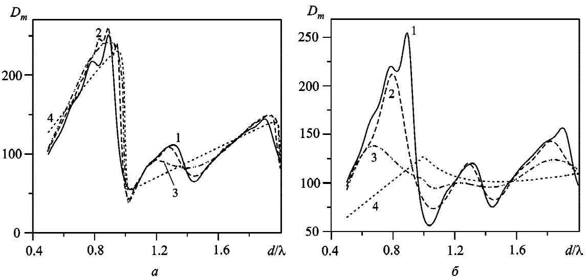
**Рис. 3.** Зависимости КНД от расстояния между элементами – диполями Герца антенной решетки из 64 излучателей с квадратной формой апертуры (кривые 1), прямоугольной (кривые 2), квазилинейной (кривые 3) и линейной (кривые 4): *a* – диполи перпендикулярны оси решетки; *б* – диполи параллельны оси решетки
