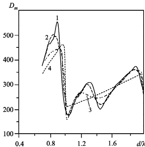
**Рис. 5.** Зависимости КНД от расстояния между элементами — прямоугольными волноводами антенной решетки из 64 излучателей с разной формой апертуры: квадратной (кривая 1), прямоугольной (кривая 2), квазилинейной (кривая 3) и линейной (кривая 4)
