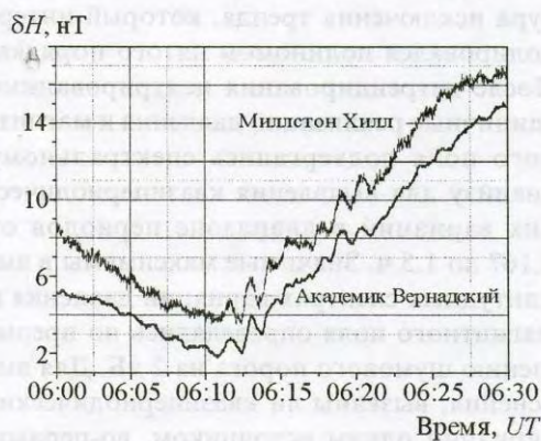
Рис. 1. Синхронные регистрации геомагнитных микропульсаций Pc4 в сопряженных регионах 6 сентября 1999 г.
