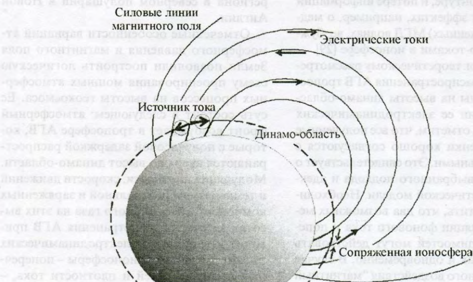
Рис. 8. Схема замыкания динамо-токов через сопряженную ионосферу. Область источника представлена в виде цепочки генераторов тока
