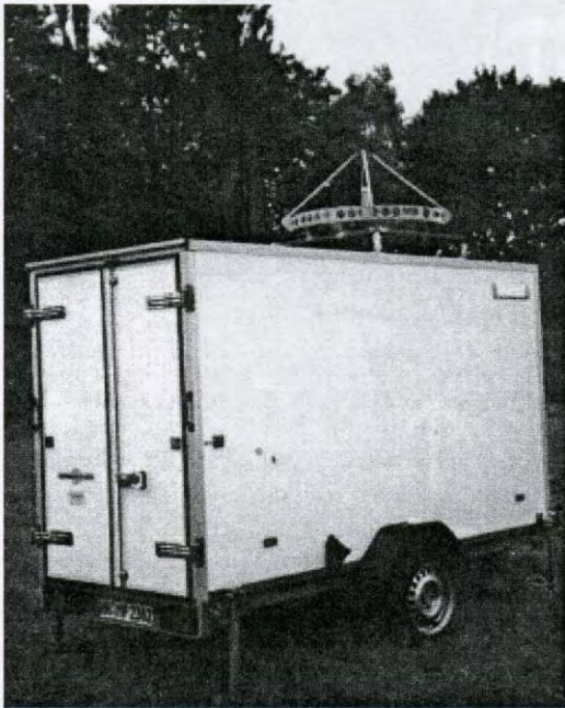
Доплеровский метеорологический локатор 8-мм диапазона. Разработка РИ. Фотография любезно предоставлена Д. М. Вавривым (РИ)
