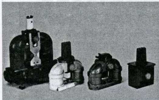
Магнетроны 2-мм диапазона в различных магнитных системах. Разработка ИРЭ. Фотография любезно предоставлена Ю. Х. Брацлавским (ИРЭ)
