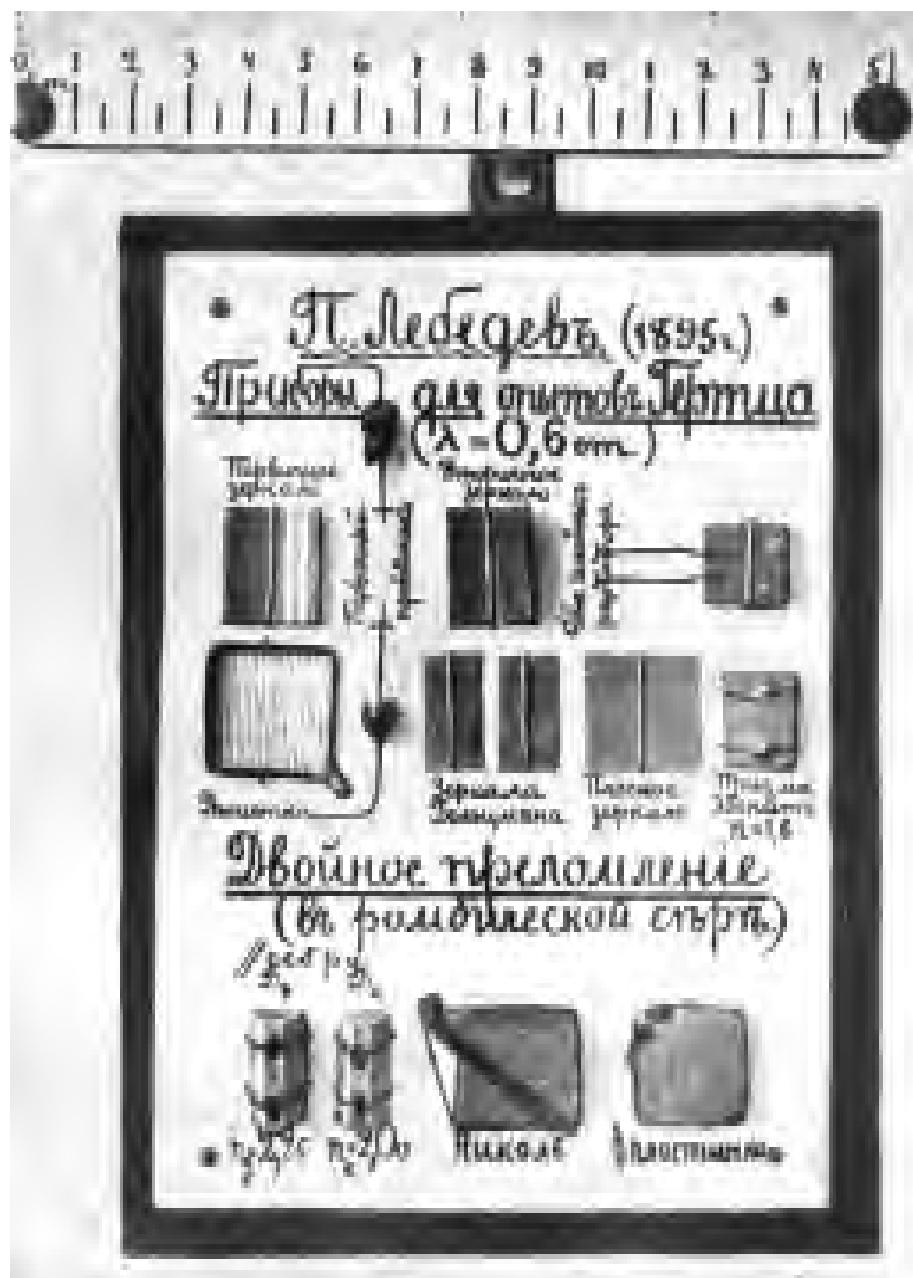
**Рис. 4.** Комплект устройств, разработанных Лебедевым для осуществления опытов Герца на волне  $\lambda = 6 \text{ мм}$ . (Репродукция из работы [26])
