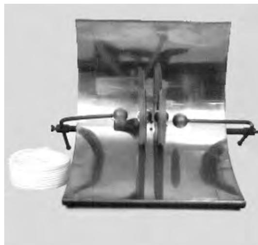
Рис. 3. Конструкция одного из вариантов осциллятора Риги с параболическим рефлектором. (Репродукция со страницы <http://www.df.umbo.it/museo/files/RIGHI.HTM> с любезного разрешения Museo di Fisica, Dipartimento di Fisica, Universita degli Studi di Bologna (Italy))
