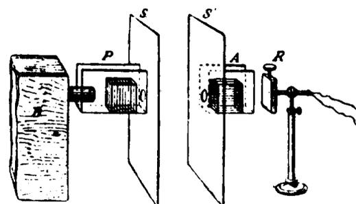
Рис. 12. Металло-пластинчатый поляризатор Бозе. (Репродукция из работы [36])
