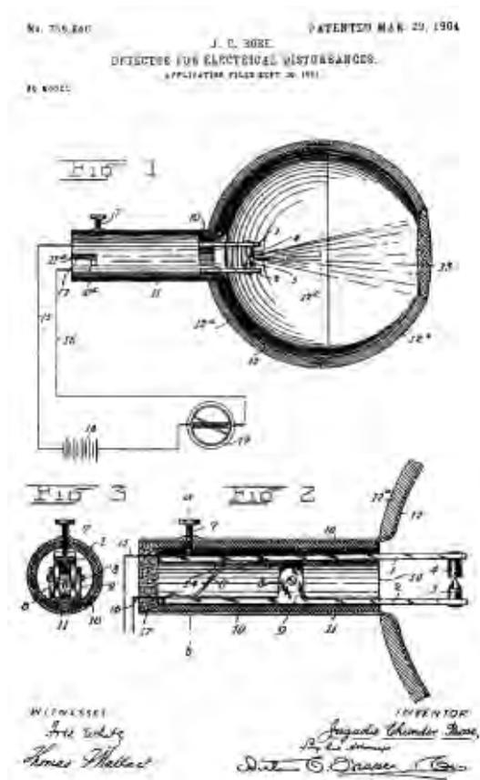
Рис. 9. Точечно-контактный полупроводниковый детектор Бозе. (Репродукция из работы [34])
