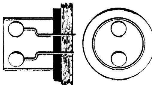
Рис. 5. Конструкция волноводного излучателя Лоджа в виде отрезка медной трубы круглого сечения. (Репродукция из работы [29])
