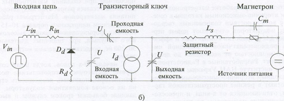
Рис. 1. Принципиальная (а) и эквивалентная (б) схемы системы магнетрон-модулятор
