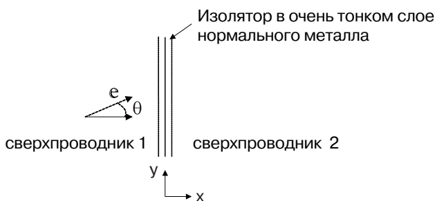
Рис. 5. Схематическое изображение рассматриваемого двумерного перехода Джозефсона.
