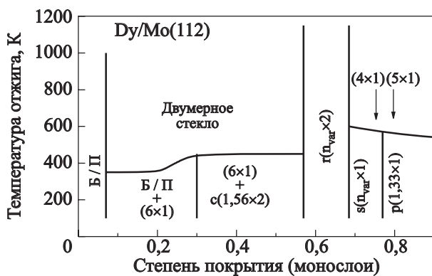
Рис. 2. Диаграмма структурных переходов, вызванных отжигом адпленок Dy на Mo(112). Обозначения на диаграмме: Б/П — беспорядок; r(n_{\text{var}} \times 2) и s(n_{\text{var}} \times 1) — прямоугольная и косоугольная структуры с параметром решетки, изменяющимся со степенью покрытия \theta ; другие обозначения соответствуют общепринятым названиям упорядоченных структур. Вертикальные стрелки указывают значения \theta , соответствующие наблюдаемым структурам. Температура наблюдений 100 К.
