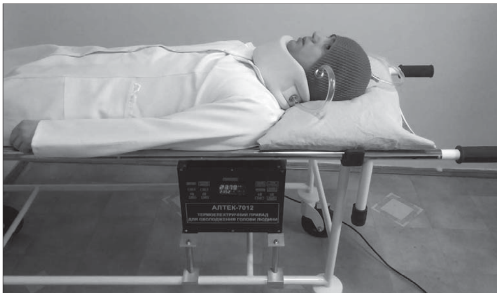
Рис. 7. Термоелектричний прилад для охолодження голови людини «АЛТЕК-7012»
