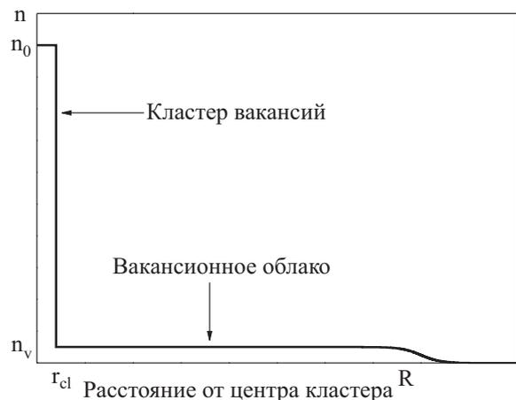
Рис. 3. Распределение концентрации вакансий  $n$  в «вакансионном облаке», содержащем кластер вакансий.
