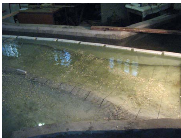
Рис. 9. Визуализация течения вблизи полотна завесы частичками, имеющими положительную плавучесть
