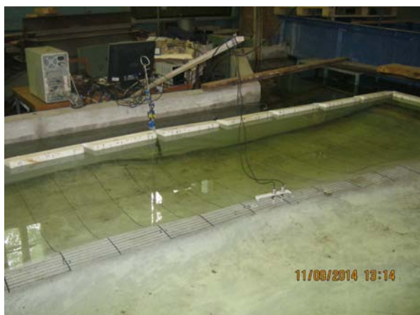
Рис. 6. Размещение датчиков скорости, давления и вибраций в измерительном участке гидродинамического канала
