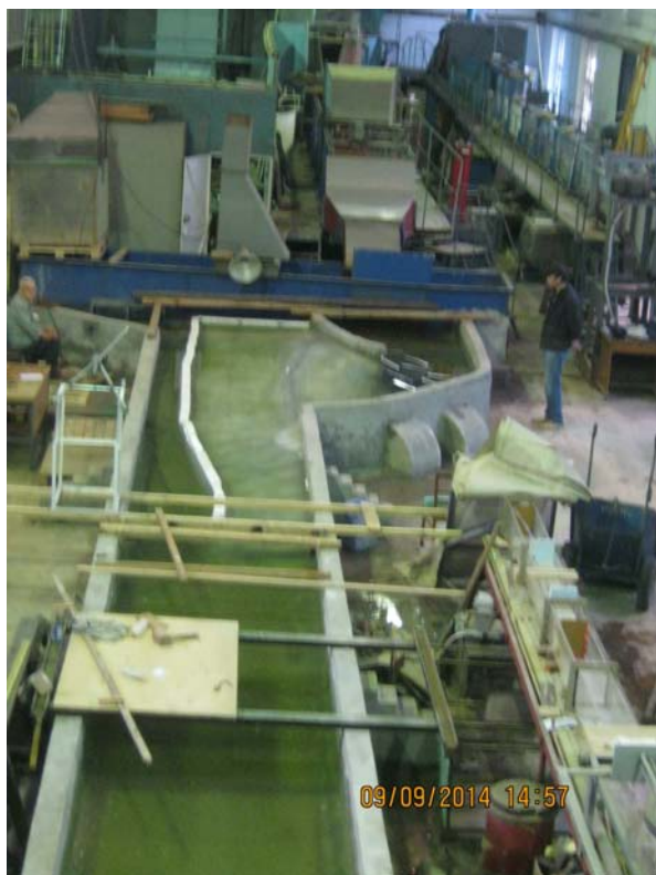
Рис. 3. Экспериментальный стенд на базе гидродинамического лотка и канала
