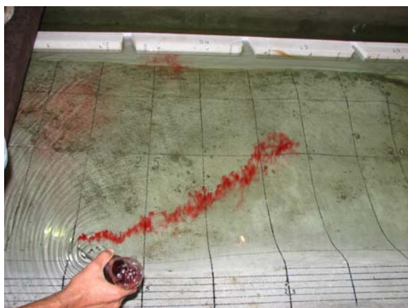
Рис. 8. Визуализация приповерхностного слоя потока перед полотном завесы
