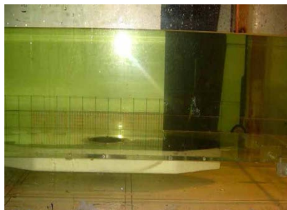
Рис. 3. Вимірювальна ділянка гідродинамічного лотку з лункою на пластині
