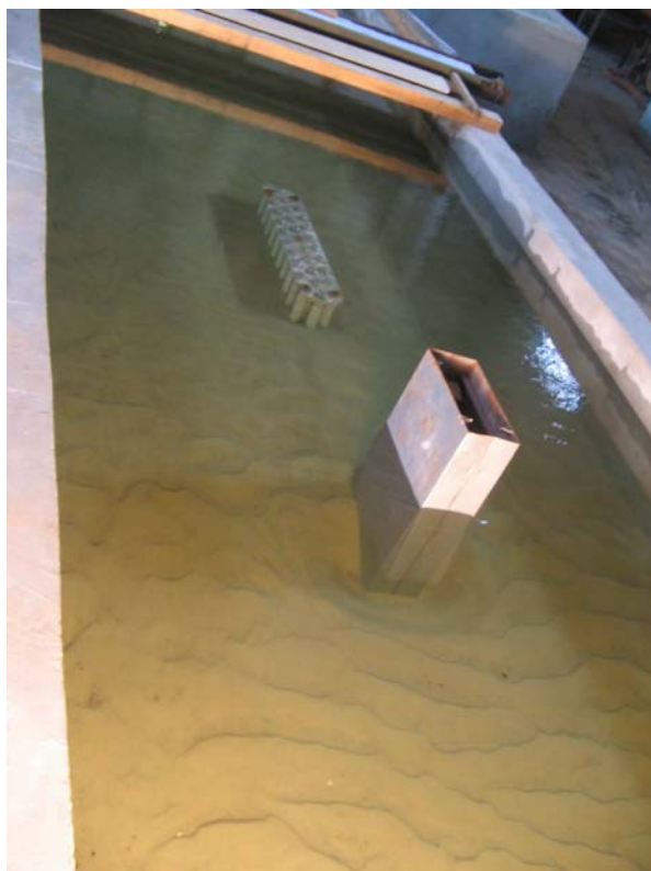
Рис. 3. Вид модели гидродинамического канала и расположение мостовых опор в ходе исследований
