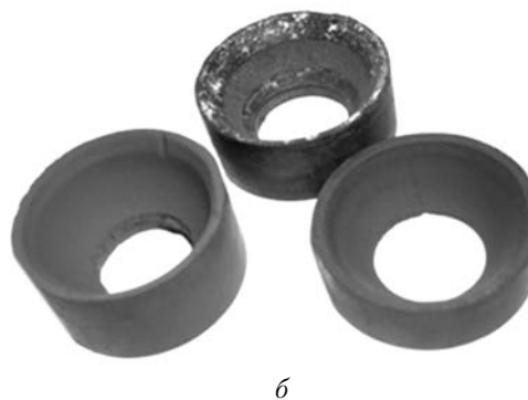
Рис. 5. Технологічна схема обробки сферичної головки по схемі вільного притирання: а — схема обробки; б — притири для обробки титанової заготовки
