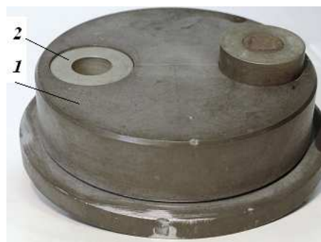
Рис. 4. Поворотная вставка для размещения различных углублений: 1 – круглая вставка диаметром 0.1 м, 2 – втулки диаметром 0.03 м для формирования углублений, расстояние между осями втулок – 0.06 м
