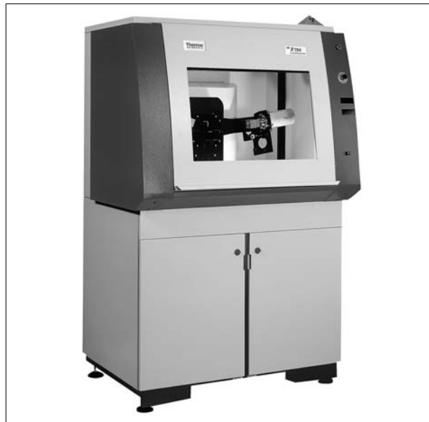
Рис. 3. Рентгеновский дифрактометр ARL X'TRA
