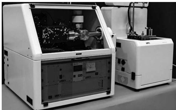
Рис. 4. Фотографія автоматичної системи характеристики каталізаторів з мас-спектрометричним детектором CATLAB, Hiden Analytical
