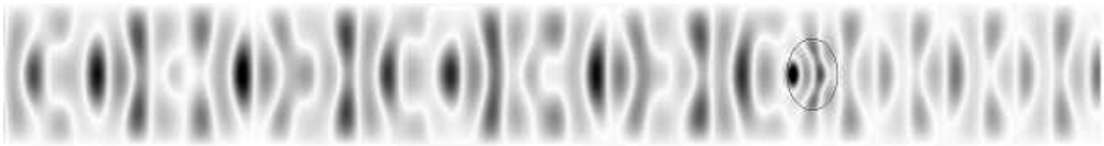
Рис. 8. Картина распределения волновых перемещений для случая c_{44} = 0.5c_* , c_{55} = c_* , R = 0.5h , \lambda = 0.7h , \delta = 0.25 .
