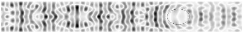
Рис. 11. Картина распределения волновых перемещений для случая c_{44} = 2c_* , c_{55} = c_* , R = 0.5h , \lambda = 0.5h , \delta = 4 .
