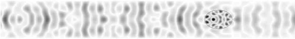
Рис. 4. Картина распределения волновых перемещений для случая c_{44} = 2c_* , c_{55} = c_* , R = 0.5h , \lambda = 0.7h , \delta = 0.25 .
