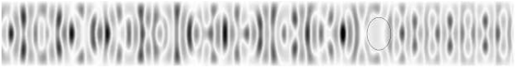
Рис. 15. Картина распределения волновых перемещений для случая c_{44} = 0.5c_* , c_{55} = c_* , R = 0.5h , \lambda = 0.5h , \delta = 4 .
