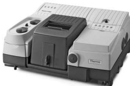
Рис. 3. ИК Фурье-спектрометр Nicolet 6700
