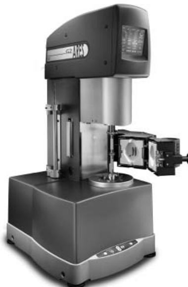
Рис. 14. Реометр ARES G2
