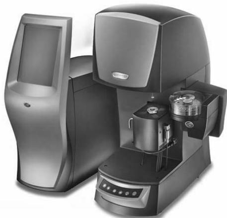
Рис. 12. Дифференциальный сканирующий калориметр DiscoveryDSC
