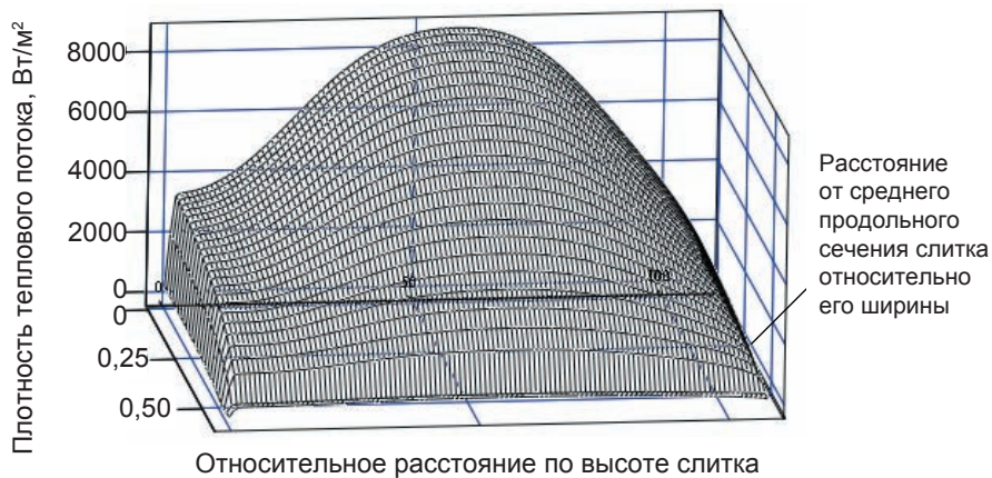
Рис. 6. Результаты расчета распределения плотности теплового потока на поверхности большей грани слитка: с учетом оплавления окалины (а); без учета (б)
