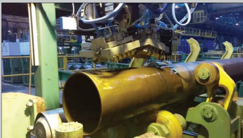
Установка НК 368ВЛ для АУЗК концевых участков бесшовных труб, ОАО «Волжский трубный завод», 2014 г.
