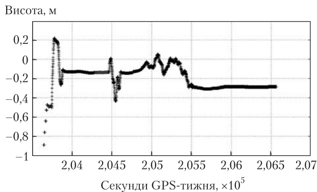
Рис. 12. Нев'язки DGPS-рішення по висоті. Розрахункова висота. Відстань 20 км
