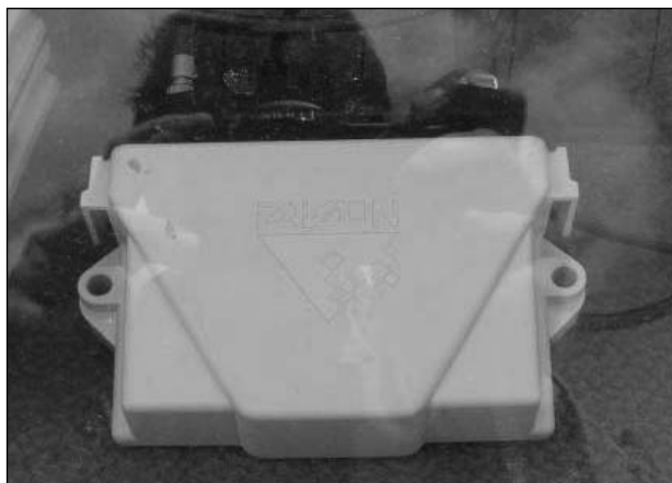
Рис. 8. Одночастотний приймач NovAtel OEMV1 в корпусі FlexPack
