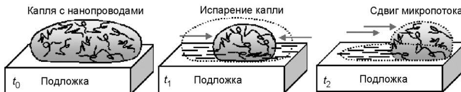
Рис. 10. Схема упорядочения нанопроводов с помощью микропотоков (моменты времени t_0 < t_1 < t_2 ) [45]
