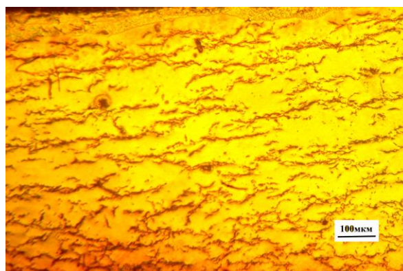
Рис. 11. Микроструктура наводороженного образца сплава Zr-1%Nb
