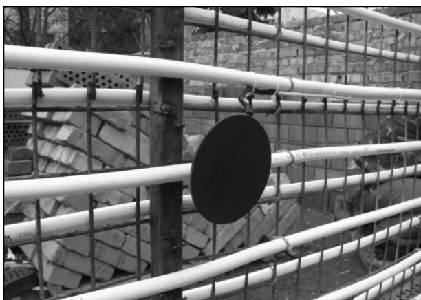
Рис. 6. Приклади установки датчиків в огорожувальних конструкціях експериментального будинку
