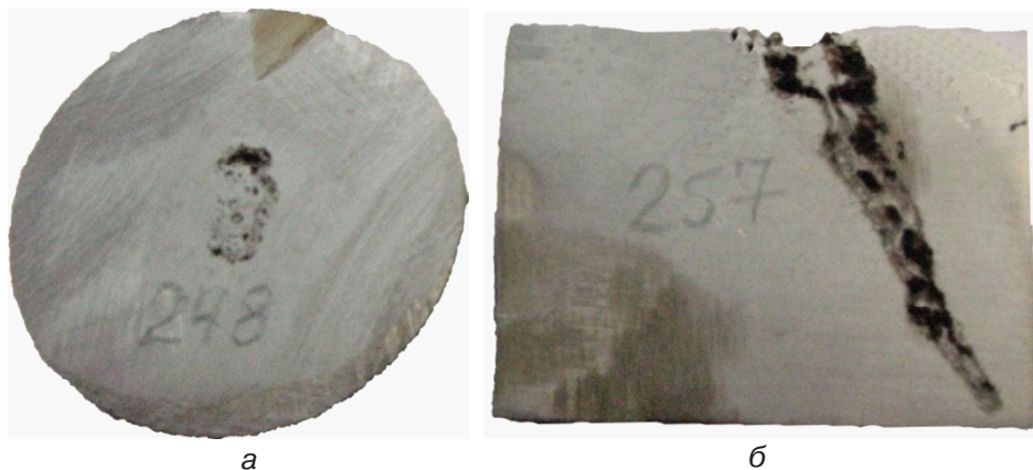
Рис. 5. Разрез чугуновых отливок с остатками образцов ферросилиция, первоначально имевших форму пластины (а), и ступенчатой пластины (б)
