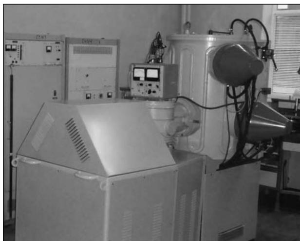
Рис. 7. Установка для нанесения покрытий
