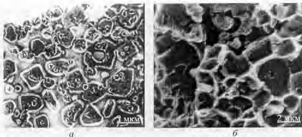
Рис. 2. Кольцевая структура карбидных зерен H18K9MST—30% TiC: а — микроструктура; б — поверхность разрушения.
