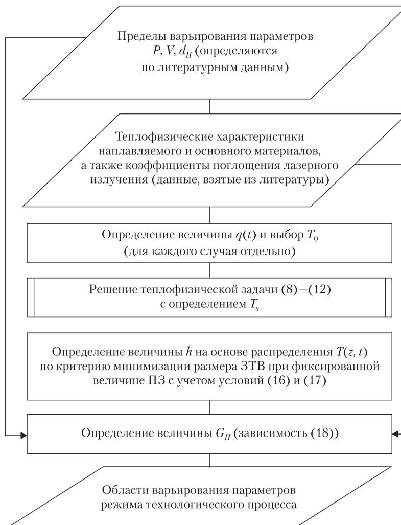
Рис. 5. Алгоритм расчетного определения технологических режимов лазерной наплавки
