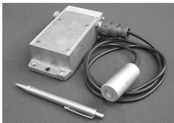
Рис. 8. Блок детектирования для контроля мощности дозы в рентгеновских полях высокой интенсивности
