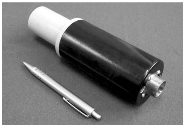
Рис. 1. Широкодиапазонный дозиметр \gamma - и рентгеновского излучений на основе CdZnTe
