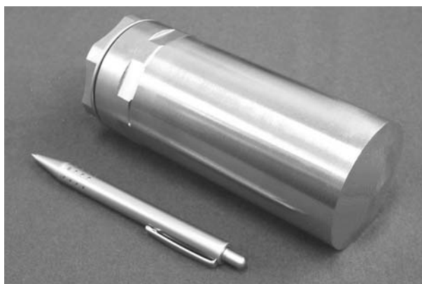
Рис. 5. Блок детектирования на основе CdZnTe для контроля мощности дозы \gamma -излучения в аварийных ситуациях
