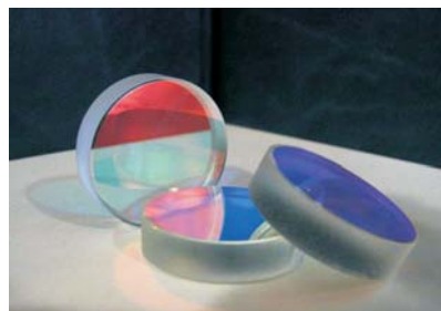
Рис. 2. Експериментальні зразки оптичних елементів для ІЧ спектроподілювача з багатошаровими покриттями на основі композитів MgF_2-LuF_3 і ZnS-GdS (ЦКБ "Арсенал")
