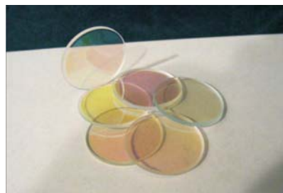
Рис. 3. Експериментальні зразки оптичних елементів для ІЧ вузькосмугового фільтра з багатошаровими покриттями на основі композитів MgF_2-LuF_3 і ZnS-GdS (ЦКБ "Арсенал")
