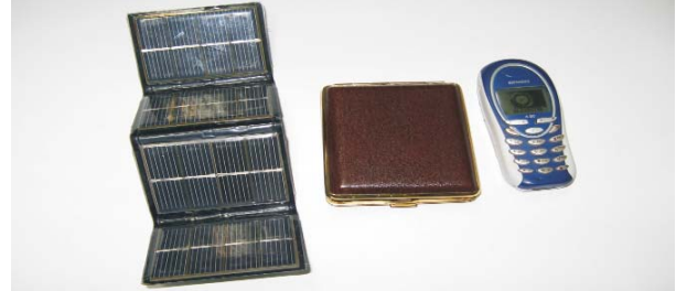
Рис. 2. Розкладна сонячна батарея для мобільних телефонів СБМТ-С-8.0-0.23 (експериментальний зразок). Праворуч від батареї лежить її футляр
