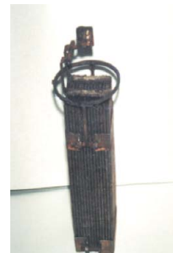
Рис. 2. Електродний блок розділення біогазу
