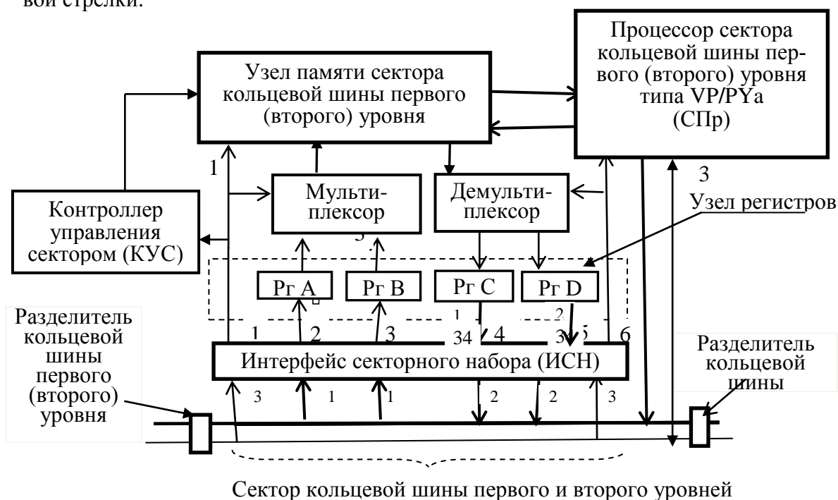
Рис. 2. Структурная схема секторного набора первого и второго уровней
