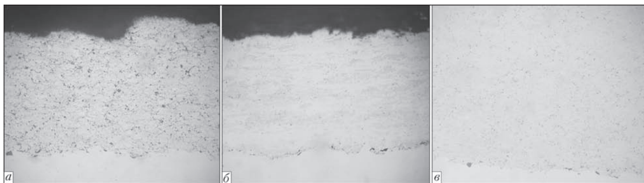
Рис. 2. Микроструктура ( \times 200 ) покрытий WC–9Co–4Cr, полученных методами детонационного напыления (а); СВГПН (б); HVOF (в)
