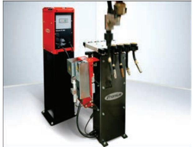
Robacta TX — автономная система для смены корпуса горелки от Fronius
