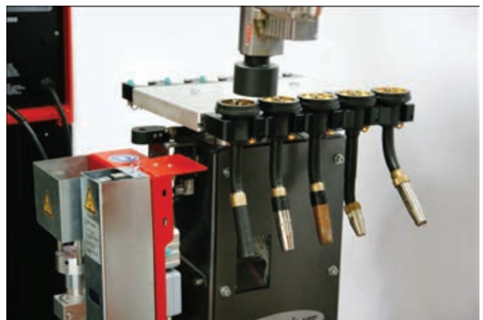
Робот меняет корпус горелки для выполнения различных сварочных задач или корпус горелки с новым контактным наконечником автономно, а также в зависимости от ситуации и потребности
