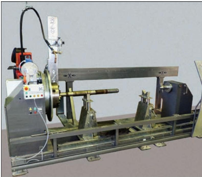
Установка АС354-5000 для наплавки роторов электродвигателей
