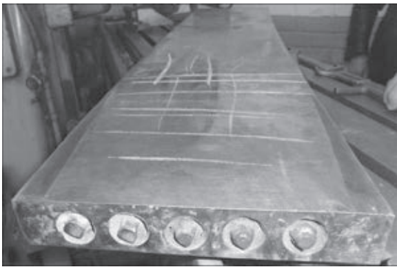
Рис. 5. Кристаллизатор МНЛЗ после эксплуатации
