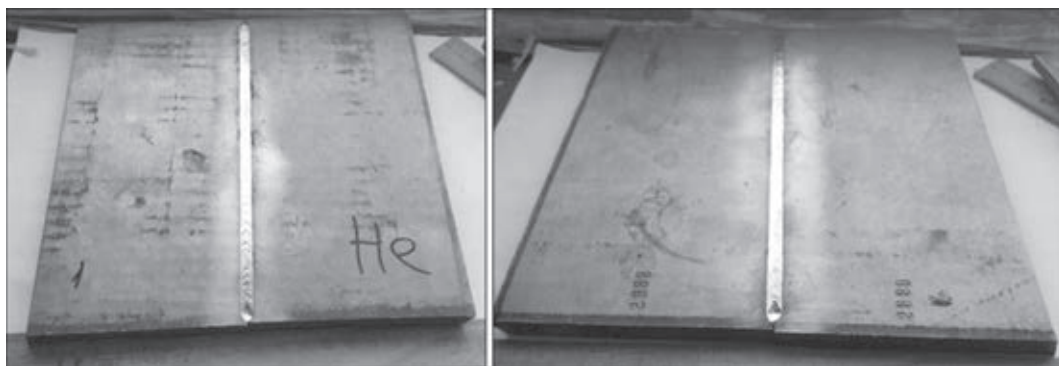
Рис. 3. Внешний вид сваренных в газовой среде He + Ar + Ar с двух сторон пластин сплава технического титана ВТ1-0 ДШП толщиной 12 мм, упрочненного азотом (0,098 мас. %)
