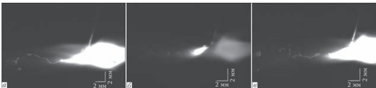
Рис. 4. Визуализация срыва капель с конца распыляемой проволоки: а — струйное течение металла; б — формирование близких по размерам капель; в — формирование капель, значительно отличающихся по размерам
