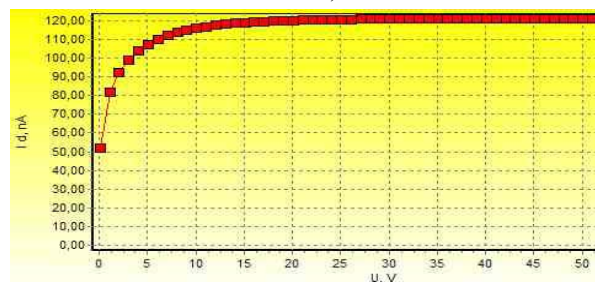
Рис. 11. Токи утечки (ВАХ) активной области детектора X31 при облучении его ускоренными электронами суммарной дозой 1530 крад
