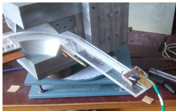
Рис. 9. Устройство для измерения поля вдоль траектории движения пучка
