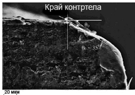
Рис. 12. Наклонная трещина фреттинг-усталости в сплаве Al 7075-T6 ( \sigma_a = 300 МПа, \sigma_{ц} = 90 МПа, \mu = 0,37 ) [13].
