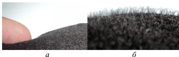
Рис. 2. Поверхность промышленного углеродного войлока (а) и модифицированная поверхность (б)
