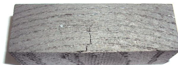
Рис. 5. Характер разрушения образцов при испытании на изгиб с трехточечной нагрузкой (в радиальном направлении)
