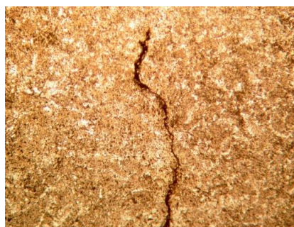
Рис. 4. Трещина в микроструктуре образца №4, H_c = 605 А/м
