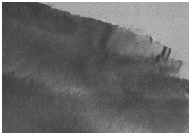
Рис. 23. Неразрешаемая радиационная микроструктура и малые объемные дефекты (возможно, поры) в Y 2 O 3 +10% ZrO 2 после облучения нейтронами ( E_n > 0,1 МэВ) дозой 3,9 \cdot 10^{21} нейтр./м 2 при температуре 752°C, ув. 150000
