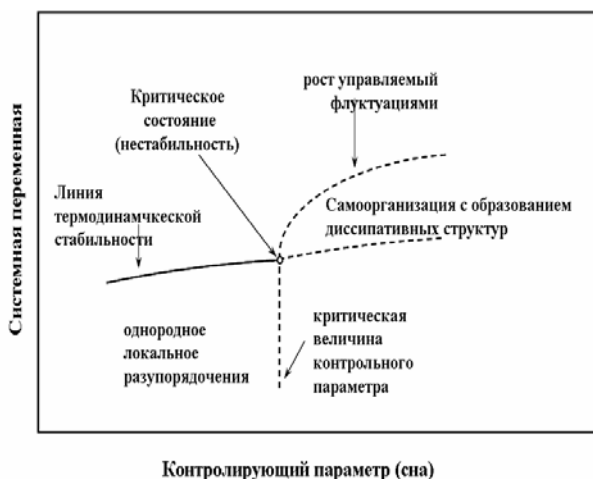
Рис. 17. Схематическая диаграмма перехода облучаемого материала в разупорядоченное состояние через точку неустойчивости (бифуркации) в новое упорядоченное состояние, когда контрольный параметр достигает критической величины. Показаны области однородного состояния, неустойчивости, роста новой фазы благодаря флуктуациям концентрации дефектов
