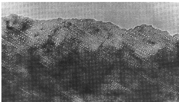
Рис. 20. Объемные дефекты (возможно, поры) в Al_2O_3 (AD-999x) после облучения нейтронами ( E_n > 0,1 МэВ) дозой 4,1 \cdot 10^{21} нейтр./ m^2 при температуре 752 °С, ув. 200000
