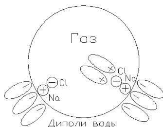
Рис. 7. Схематический вид структуры водо-газосолевых образований
