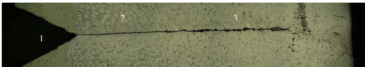
Рис. 4. Панорама трещины на поверхности дискового образца после испытания на термошок: 1 – концентратор; 2 – усталостная трещина; 3 – проскок трещины при термошоке и ее остановка
