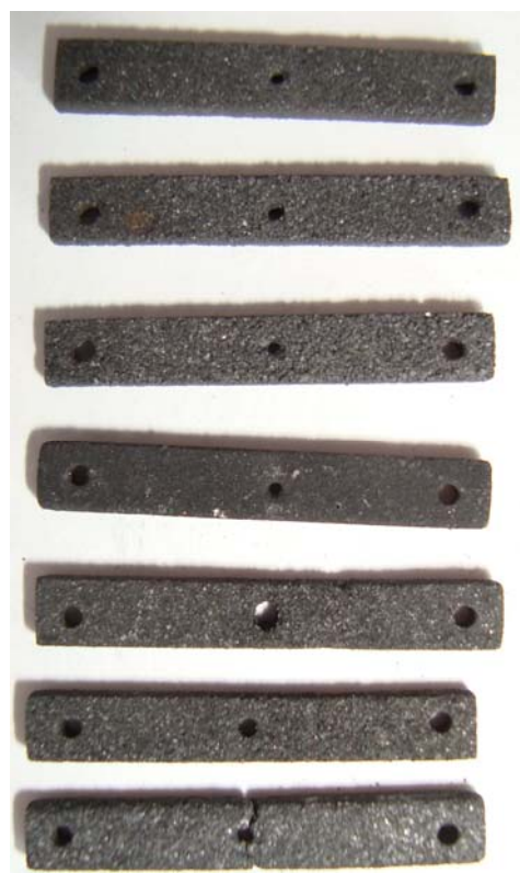
Рис. 5. Изменение внешнего вида поверхности образцов в процессе их окисления под облучением при температуре ~ 600 °С: а – исходные образцы; б – после 1 ч облучения; в – после 5 ч облучения; г – после 6 ч облучения
